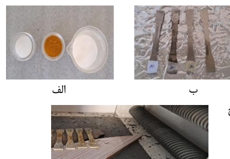
شکل ۶- مراحل پاشش نمک خورنده بر سطح نمونه‌ها: (الف) ترکیب نمک خورنده، (ب) نمونه‌ها قبل از خوردگی و (ج) نمونه‌ها پس از قرارگیری داخل کوره
