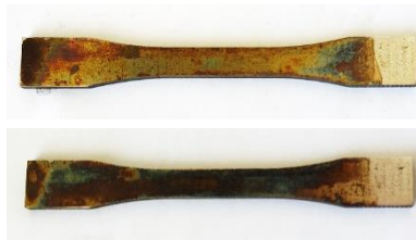
شکل ۳- روش لایه نشانی اکسیدگرافن بر زیرلایه الف) حمام الکترولیت، ب) شماتیک فرآیند پوشش‌دهی [۲۱] ج) نمونه پس از ۵ مرحله پوشش‌دهی و د) نمونه پس از ۱۰ مرحله پوشش‌دهی
