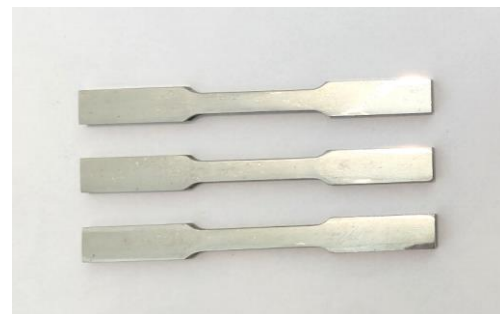
شکل ۱- ابعاد نمونه‌های آزمون کشش بر حسب میلی‌متر و نمونه‌های تهیه شده از ماده اولیه
