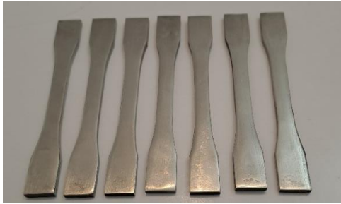
شکل ۲- شکل و ابعاد نمونه آزمایش خستگی بر حسب میلی‌متر
