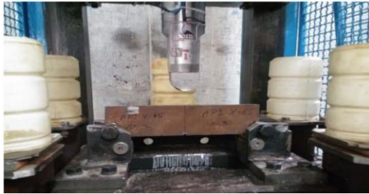
شکل ۲- نمونه آزمایشگاهی قرار داده شده در کارگیر ماشین ضربه سقوطی
