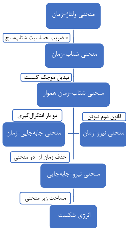
شکل ۷- فرایند استخراج انرژی شکست نمونه از سیگنال شتاب
