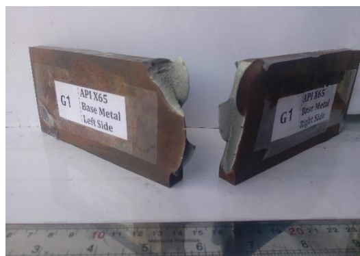
شکل ۴- نمونه شکسته شده بعد از انجام آزمایش
