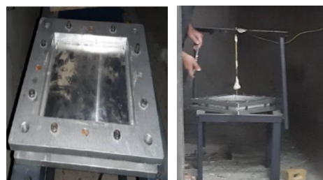
شکل ۷- تست انفجار آزاد بر روی ورق ساندویچی
