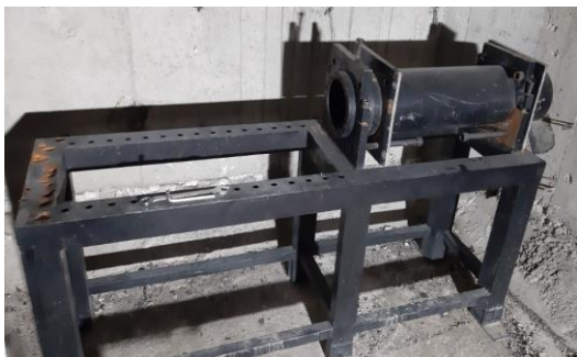
شکل ۳-لوله شوک مینیاتوری مورد استفاده
