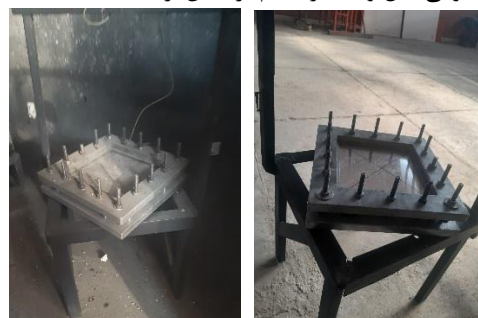
شکل ۱۸- نمونه با رویه آلومینیومی قبل و بعد از آزمایش
