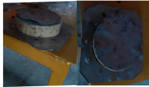
شکل ۱۱- نمونه با هسته‌ی فومی پس از تست
