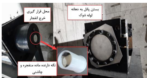
شکل ۴-اتصال ورق ها به لوله شوک جهت آزمایش
