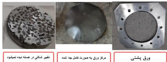
شکل ۱۲- نمونه با هسته‌ی آلومینیومی و رویه آلومینیوم
