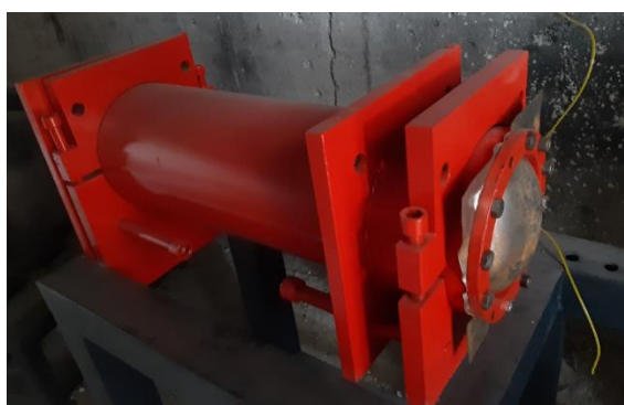
شکل ۱۰- تست ورق ساندویچی با هسته ترکیب رزین و پوکه معدنی
