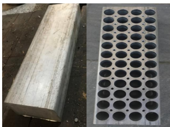
شکل ۲- بلوک آلومینیومی قبل و بعد از تراشکاری CNC و محل قرارگیری سلول‌ها
