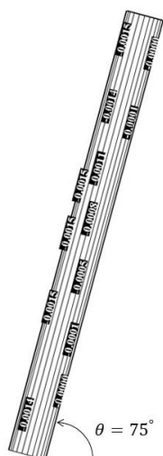
شکل ۴- خطوط جریان درون میکروکانال در \theta=75^\circ در Gr=0 Re=10
