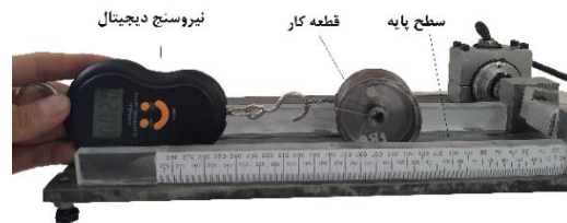
شکل ۳- اندازه گیری ضریب اصطکاک سطح تماس قطعه کار و سطح پایه
