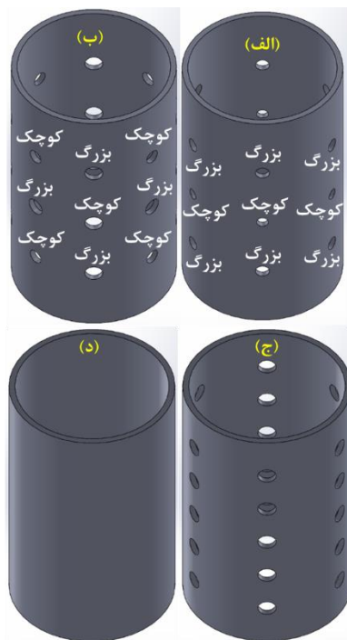
شکل ۱- شماتیک لوله‌های در نظر گرفته شده الف: با سوراخ‌های غیرهم‌اندازه منظم، ب: با سوراخ‌های غیرهم‌اندازه نامنظم، ج: با سوراخ‌های هم‌اندازه، د: بدون سوراخ
