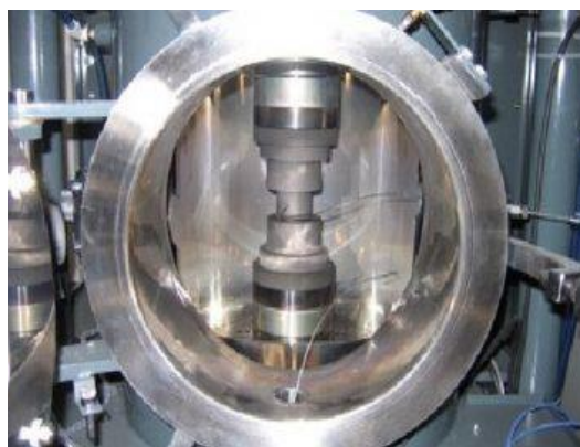
شکل ۶ - تصویر محفظه داخلی (قالب‌های گرافیتی) تحت خلأ دستگاه sps
