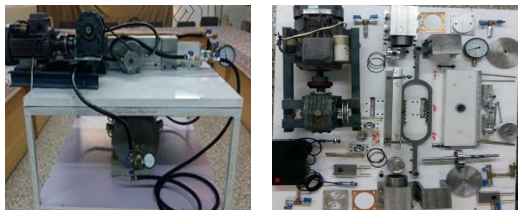
شکل ۳- موتور کمپرسور در دو وضعیت مونتاژ و دیمونتاژ
