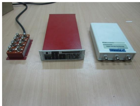
شکل ۷- تجهیزات مورد نیاز جهت اندازه‌گیری کرنش
