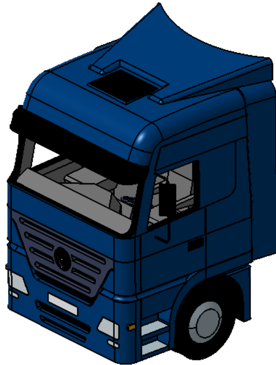
شکل ۳- طراحی پوسته بنز اکتروس نظامی در نرم‌افزار کتیا
