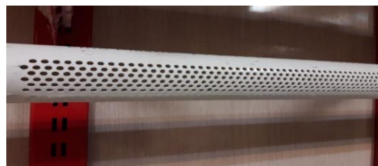
شکل ۲- نمایی از اتاقک و دریچه مورد استفاده (الف) اتاقک آزمایشگاهی و (ب) دریچه جت‌های هم‌شار مورد استفاده
