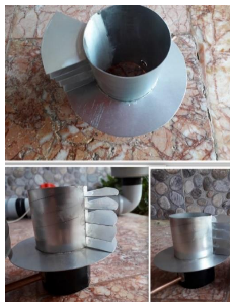
شکل ۵- مدل جدید ساخته شده با پره‌ها ۱۰ درجه نسبت به افق
