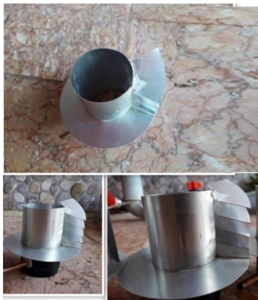
شکل ۷- مدل جدید ساخته شده با پره‌ها ۲۰ درجه نسبت به افق
