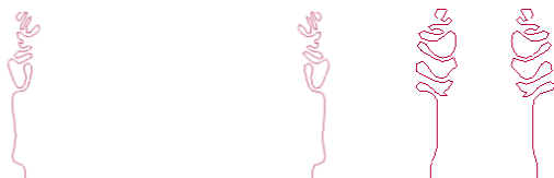
شکل ۱۵- مود تغییر شکل پروفیل TCS1.3 در دو صفحه عبور کننده از محور با اختلاف زاویه ۴۵ درجه به صورت متقارن محوری
