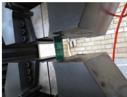
شکل ۱۷- نحوه قرارگیری قطعه تعمیر شده در دستگاه
