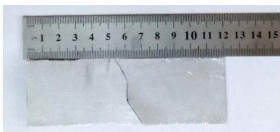
شکل ۱۰- تصویر قطعه با ترک اولیه به طول 10mm پس از انجام تست کشش تا گسیختگی کامل
