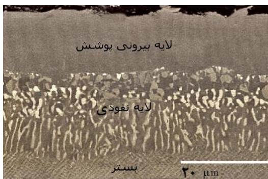
شکل ۴- تصویر SEM از پوشش پودری
