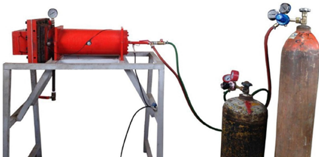
شکل ۱- سامانه انفجار مخلوط گازها
