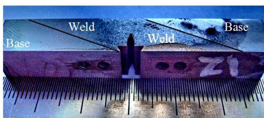
شکل ۴- موقعیت شیار در ناحیه جوش در نمونه آزمون خمش سه نقطه ای (بعد از انجام ماکرو اچ) [۱۷]
