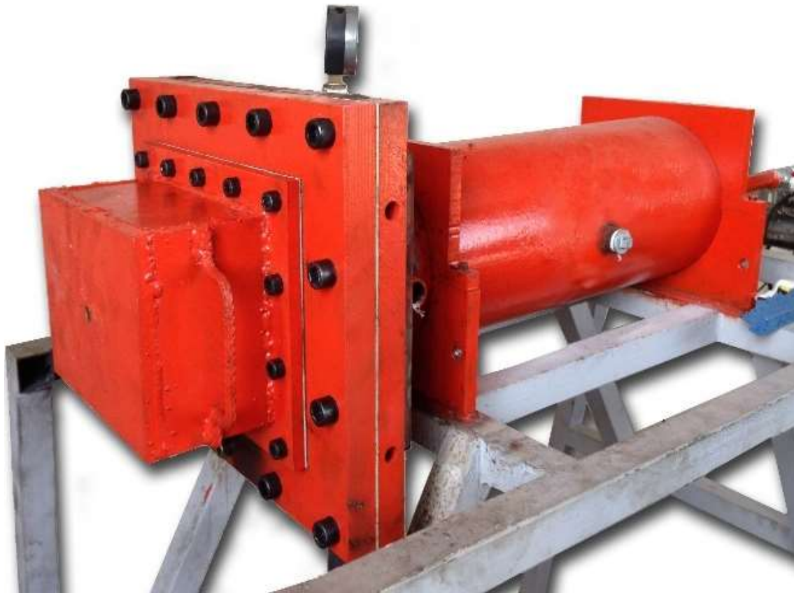
شکل ۱- تصویر سامانه انفجار مخلوط گازها جهت تحلیل تجربی
