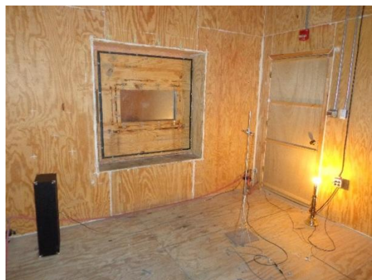
شکل ۸- نمایی از اتاق پربازتاب و ورق مستطیلی تحت آزمایش
