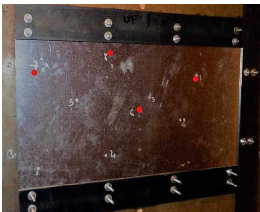
شکل ۳- چهار موقعیت اتصال شتاب‌سنج بر روی ورق مشخص شده با دایره قرمز رنگ
