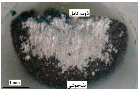
شکل ۶- منطقه ذوب کامل و تفجوشی
