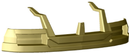
شکل ۱- مدل تیر سپر خودروی سمند
