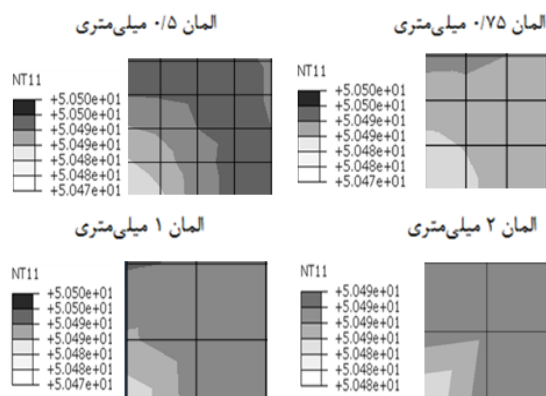
شکل ۱۲- تأثیر اندازه‌ی المان بر توزیع دمایی روی سطح در زمان حداکثر اختلاف دمایی بین نواحی سالم و معیوب در فرکانس ۰/۱۲ هرتز
