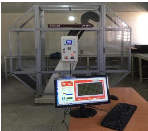
شکل ۳- نمای کلی از دستگاه ضربه شاری مجهز شده سنتام مدل SIT-450
