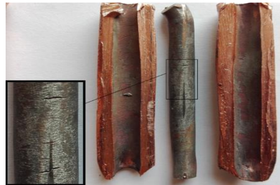
شکل ۶- وجود ترک‌های سطحی روی بیلت بعد از اعمال گذر سوم ایکپ در حالت بدون فشار پستی
