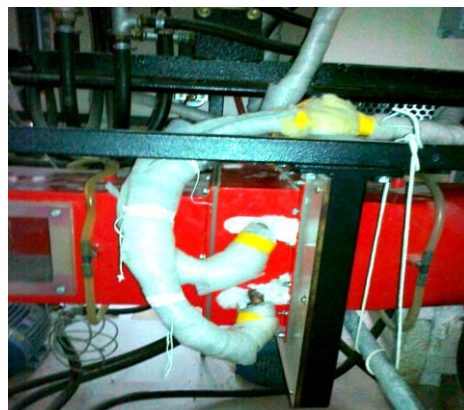
شکل ۳- نمای جانبی تونل باد با لوله‌های ورود و خروج آب مبدل
