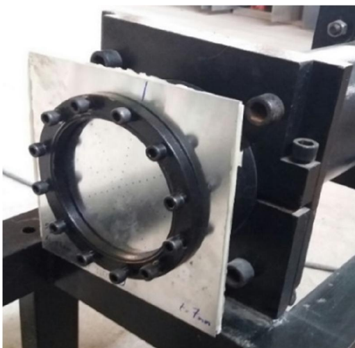
شکل ۴- اتصال تمام گیردار نمونه به لوله شاک
