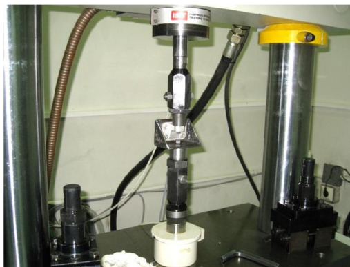
شکل ۵- دستگاه تست خستگی براکت درب هواپیما
