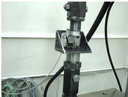
شکل ۶- ایجاد شکست خستگی در براکت درب هواپیما
