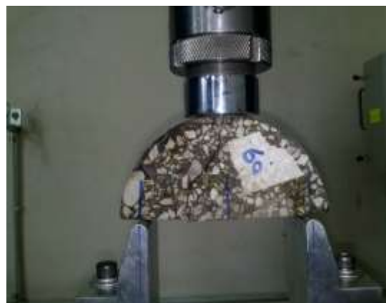
شکل ۹- نحوه بارگذاری خمشی سه‌نقطه‌ای در دستگاه آزمایش یونیورسال
