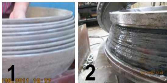
شکل ۴- لولای منعطف، رینگ های فلزی قبل از لایه چینی لایه های لاستیک (۱) بعد از پخت لایه های لاستیک (۲)
