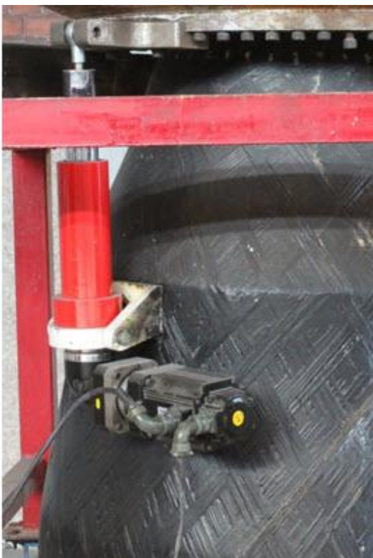
شکل ۱۰- اکچوایتور خطی در تست هیدرواستاتیک
