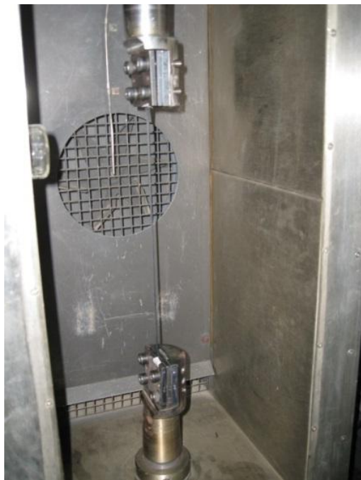
شکل ۵- تست کشش لاستیک در چمبر حرارتی
