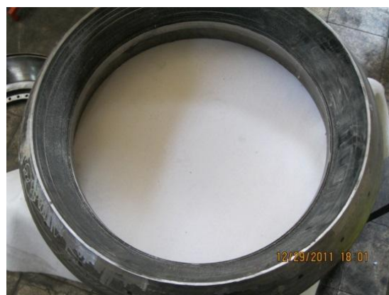
شکل ۳- لولای منعطف شامل لایه های فلزی و الاستومری بعد از ماشینکاری
