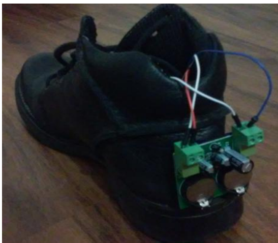
شکل ۱۰- نحوه قرارگیری مدار برداشت انرژی در یک کفش
