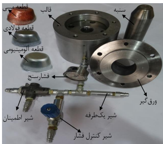
شکل ۳- اجزای قالب به همراه نمونه قطعات شکل‌دهی شده
