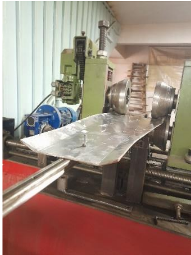
شکل ۶- نمایی از شکل‌دهی ورق دولایه توسط دستگاه شکل‌دهی غلتکی انعطاف‌پذیر
