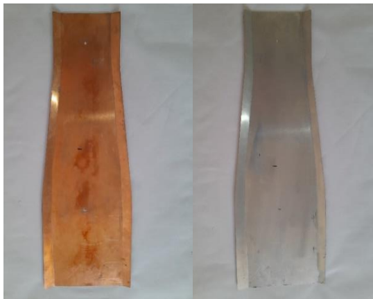
شکل ۷- محصول نهایی با ترتیب لایه الف) مس-آلومینیوم (Al-Cu)، ب) آلومینیوم-مس (Cu-Al)
