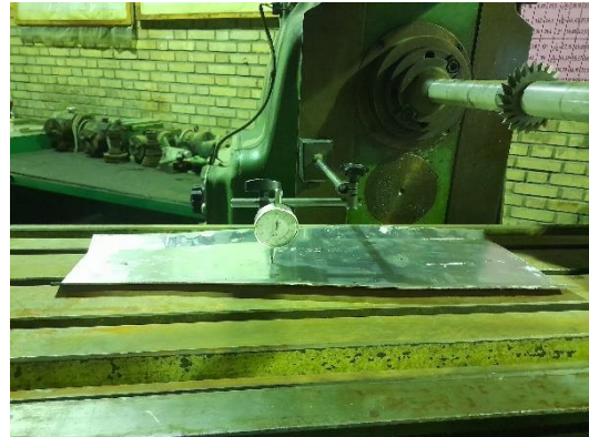
شکل ۸- روش اندازه‌گیری تجربی میزان عیب
