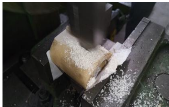
شکل ۷- الف: نمایش کانتور تنش با شرایط v=275\text{mm/s} ، ب: نمایش شکل براده در شبیه‌سازی ج: نمایش شکل براده در آزمایش تجربی
