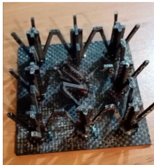
شکل ۱۹- شکست هسته خرابایی با برخورد گلوله به ۱/۴ هسته
