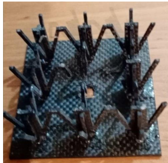
شکل ۱۸- شکست هسته خرابایی با برخورد کامل گلوله به هسته
