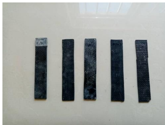
شکل ۴- نمونه لمینیت های الیاف کربن در تست کشش
