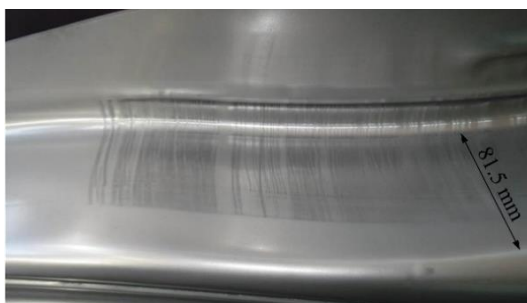
شکل ۳- آثار خراش ایجاد شده ناشی از گالینگ بر روی یک قطعه کشتش عمیق
