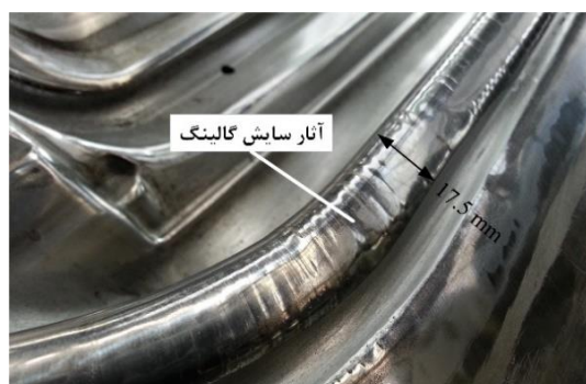
شکل ۱- سایش و خراش ایجاد شده در لبه و گوشه یک نمونه قالب کشتش عمیق از جنس آلیاژ GGG60
