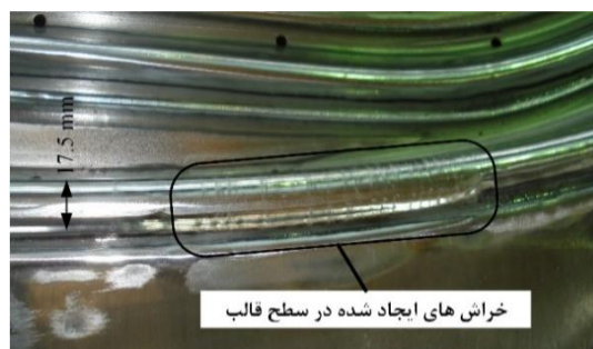
شکل ۲- خراش‌های ایجاد شده در لبه قالب ناشی از ذرات ساینده ایجاد شده در حین سایش گالینگ
