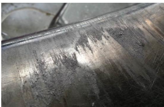
شکل ۸- آثار ذرات ساییده تشکیل شده در سطح قالب کشش در استفاده از ورق DC04
