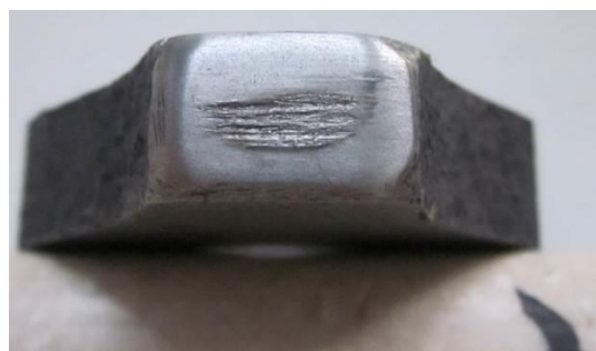
شکل ۱۳- سایش در سطح تخت لغزنده بعد از ۲۰ متر حرکت لغزنده روی ورق DC04
