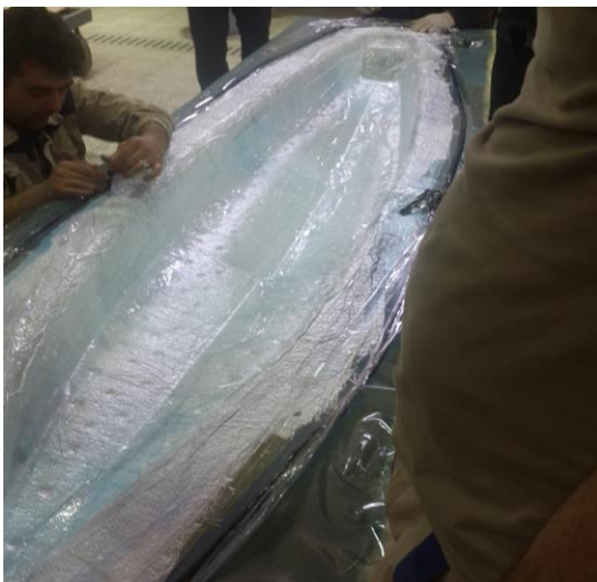
شکل ۱۴- ساخت مدل کامپوزیتی با روش وکیوم بگ
