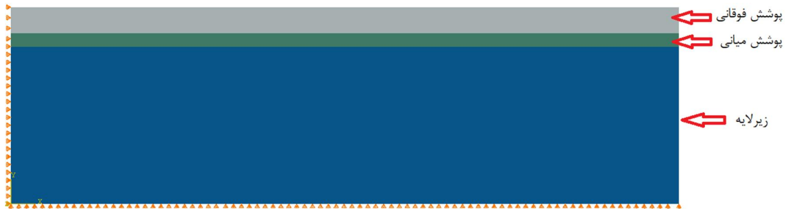
شکل ۳- مدل ارائه شده از پوشش‌های سد حرارتی شامل زیرلایه، پوشش میانی و پوشش فوقانی
