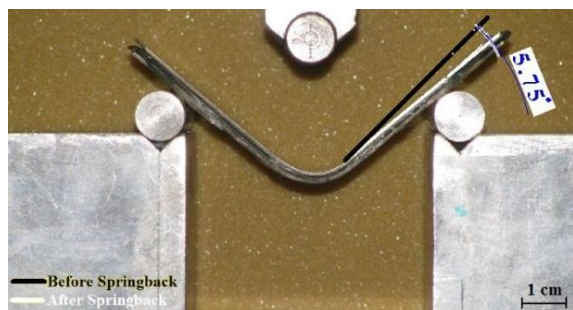
شکل ۳- اندازه‌گیری مقدار زاویه بازگشت فنی ورق
