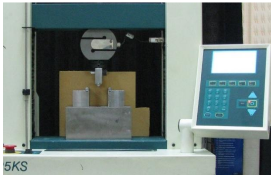
شکل ۲- روش اجرایی آزمایش خم‌کاری سه‌نقطه
