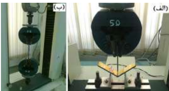
شکل ۱- نمایی از الف) فرآیند خمش و ب) فرآیند کشش
