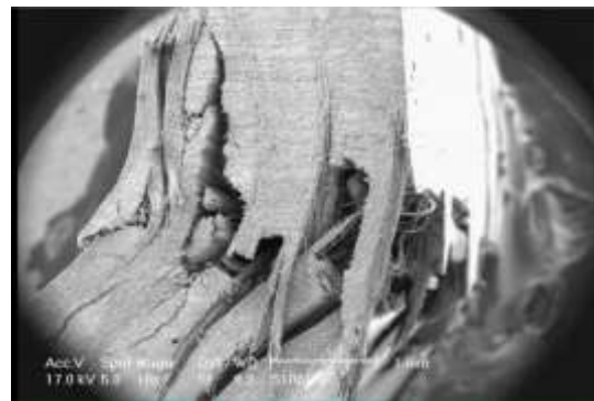
شکل ۶- شکست‌های ایجاد شده در نمونه بازالت خالص
