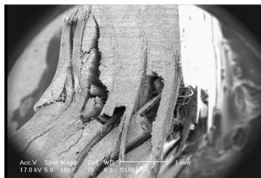
شکل ۶- شکست‌های ایجاد شده در نمونه بازالت خالص
