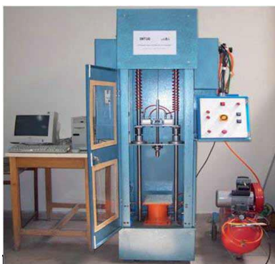
شکل ۱- دستگاه آزمون ضربه ثقلی
