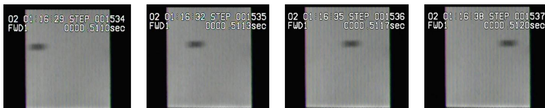
شکل ۱۱- استفاده از روش سایه نگاری جهت ثبت سرعت خروجی گلوله به وسیله دوربین سرعت بالا
