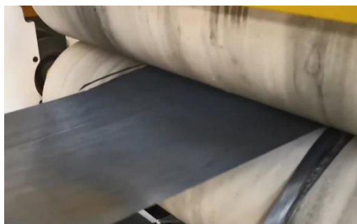
(ب) ترکیب نهایی پیش آغشته بعد از پرس بین دو غلتک شکل ۲- نحوه آغشته سازی الیاف کربن و ماده زمینه پلی فنیلن سولفایید
