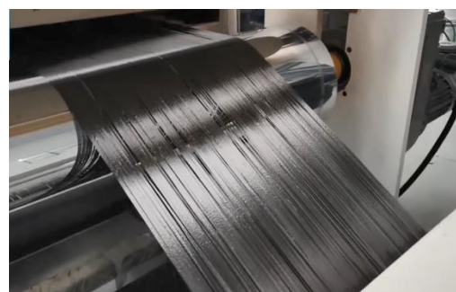
(الف) آغشته شدن الیاف کربن به پلی فنیلن سولفایید
