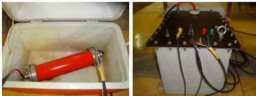
شکل ۲- (الف) ترانسفورماتور (ب) مقاومت منبع تغذیه مستقیم
