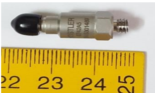
شکل ۴- شتاب‌سنج کیستلر نصب شده روی چکش دستگاه
