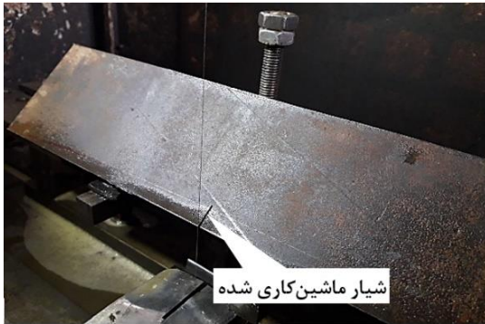
شکل ۲- ایجاد شیار ماشین‌کاری شده در نمونه به روش برش با سیم
