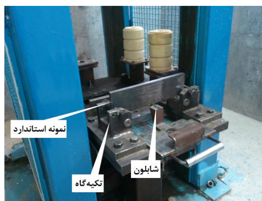
شکل ۵- قرار گرفتن نمونه روی تکیه‌گاه در دستگاه آزمایش ضربه سقوطی
