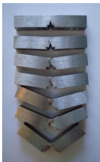
شکل ۶- نمونه‌های آزمایش شده با اعمال جابجایی متفاوت
