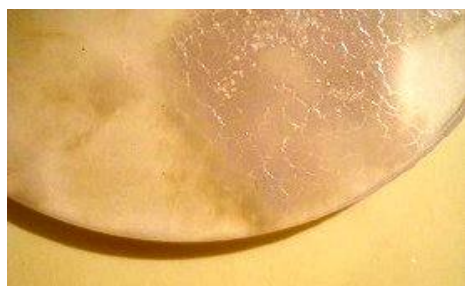
شکل ۹- آسیب در سطح نمونه پلی کربنات پس از بازپخت
