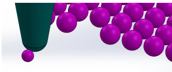
(الف) سوزن در حال تماس با یک ذره بر روی یک بستر
