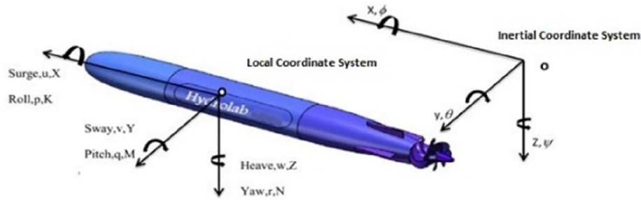
شکل ۱- جهات حرکت و چرخش در دستگاه مختصات اصلی و محلی
