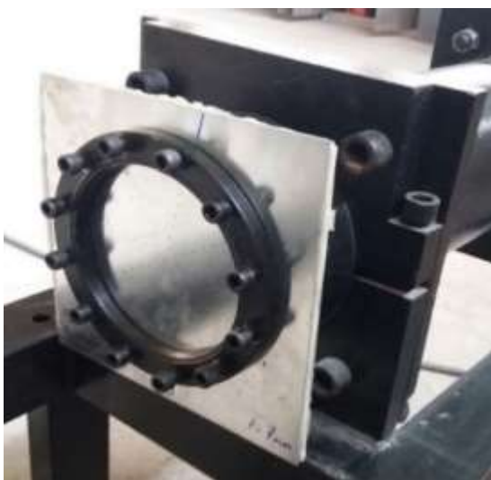
شکل ۴- اتصال تمام گیردار نمونه به لوله شاک
