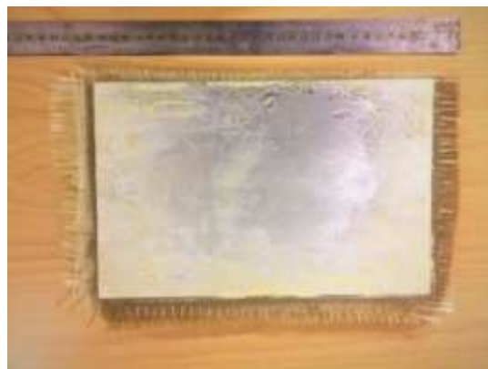
شکل ۱- نمایی از نمونه ساخته شده به صورت یک تکه با ابعاد 28 \times 18 \text{ cm}^2
